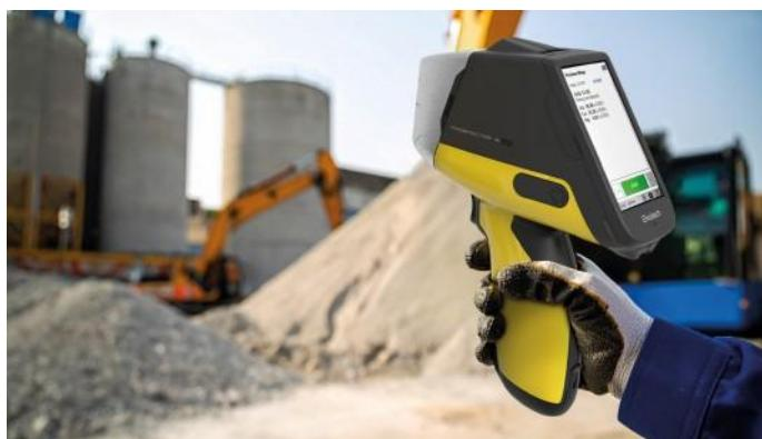
En la fabricación de cemento, ProSpector 3 Advanced proporciona un control preciso de la calidad del clinker y del cemento mediante un análisis elemental exhaustivo. Sus filtros automáticos reducen las interferencias de fondo, lo que garantiza lecturas rápidas y claras que aumentan la eficiencia de la producción y reducen el desperdicio de material.
